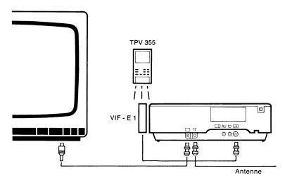
Sie haben ein TV-Fremdgerät, dann bietet sich die Kombination VIF-K 1 (Video-Fernbedien-Kombitation 1) an. Sie besteht aus einem Telepilot TPV 355 und dem Infrarot-Empfänger VIF-E 1.
