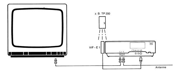
Sie haben einen GRUNDIG Fernsehgerät der preiswerten Mittelklasse, dann können Sie mit dem dazugehörigen Telepilot den Recorder ebenfalls -- unter Hinzunahme des Fernbedien-Empfängers <u>VIF-E 1</u> -- drahtlos fernbedienen.
