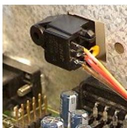
Man kann auch den billigeren **TOTX178** (Bilder links) verwenden, jedoch sollte dann das optische Kabel nicht länger als 5m sein - die beiden anderen (173 und 176) können 10m treiben. Der Anschluss ist auch viel einfacher: drei Leitungen anschliessen ("Signal" an Pin 5 des CS49xx) - fertig. Doch sollte man einen
